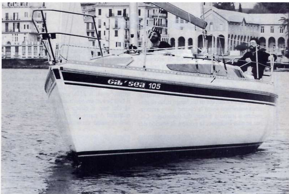
La prua molto marina del Gib'Sea 105. Questo sloop di 10,80 metri della Gibert Marine viene venduto in due versioni: crociera/comfort con deriva fissa o deriva mobile e crociera/regata con deriva fissa. Quest'ultima versione è dotata di un'albero più alto (1,36 metri in più) e di una conseguente maggior superficie velica.
