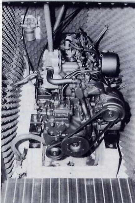
Il 30 cavalli (montato a richiesta) diesel della Yanmar, (Yamaha) un vero gioiellino della tecnica nipponica. Sul Gib'Sea versione standard viene installato il 15 cavalli della stessa casa. Dalla foto si può notare, la comodità di accesso al vano motore.
